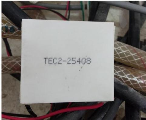
Gambar 2.5 Termoelektrik tipe TEC2-25408
